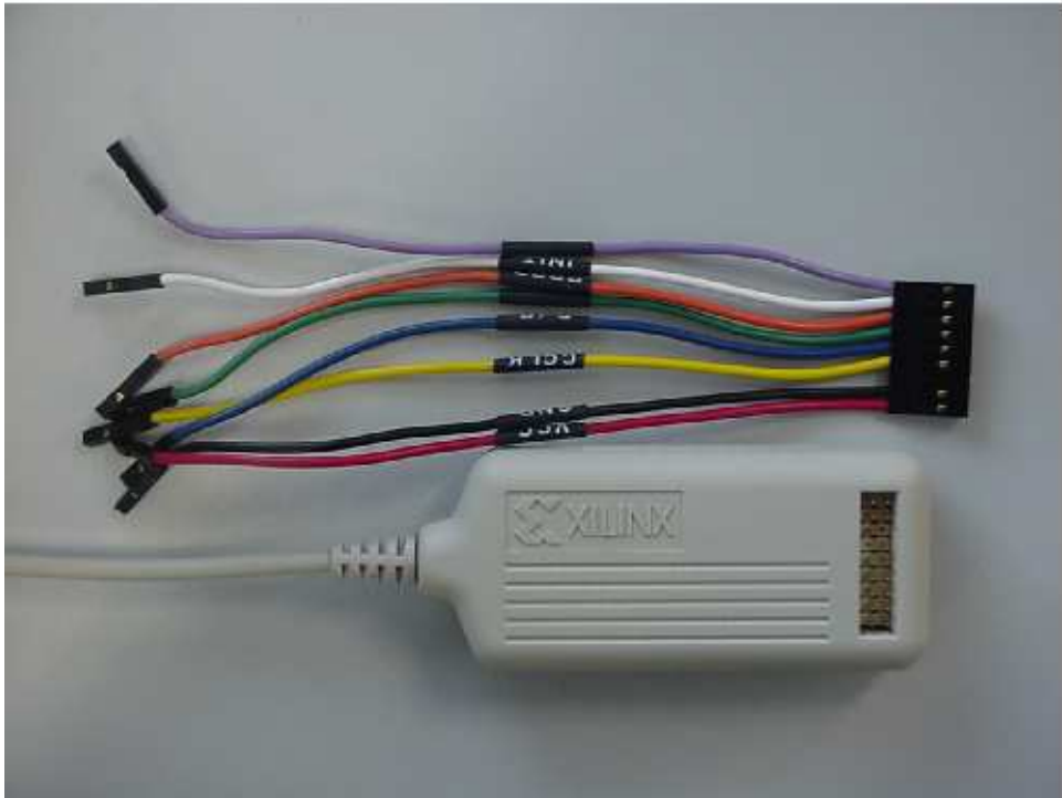
Figura 5.6.: Aspecto del cable de descarga paralelo suministrado por Xilinx
