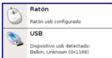
Ventanas automáticas que nos indican una conexión en caliente exitosa.
